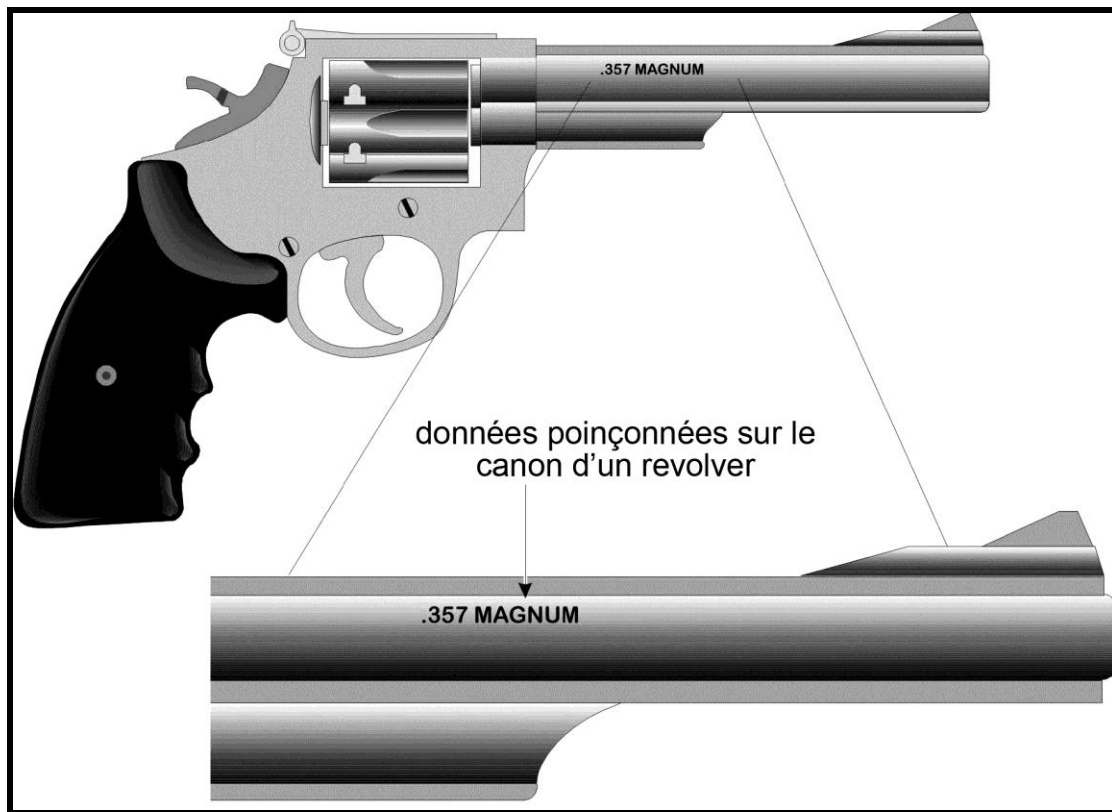
Figure 93. Exemple d'un poinçon de canon
