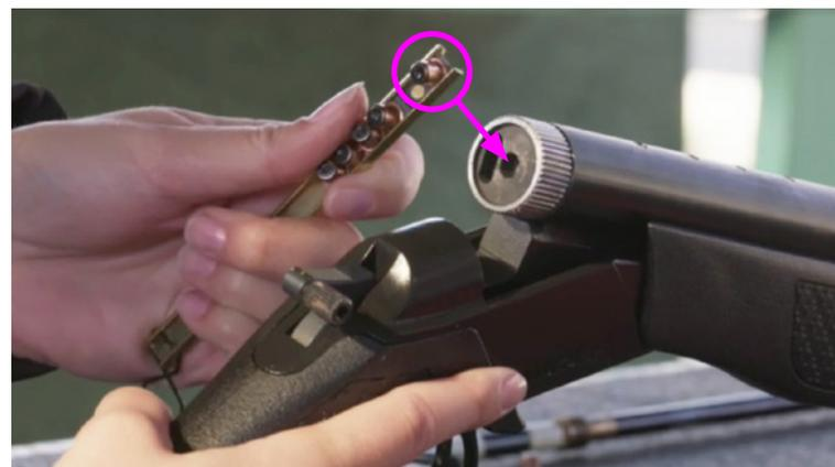
Figure 5.16 Chargement de l'amorce dans le bouchon de la culasse
