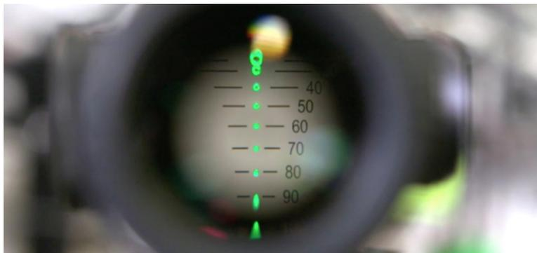
Figure 5.13 Réticule gradué en fonction de la distance
