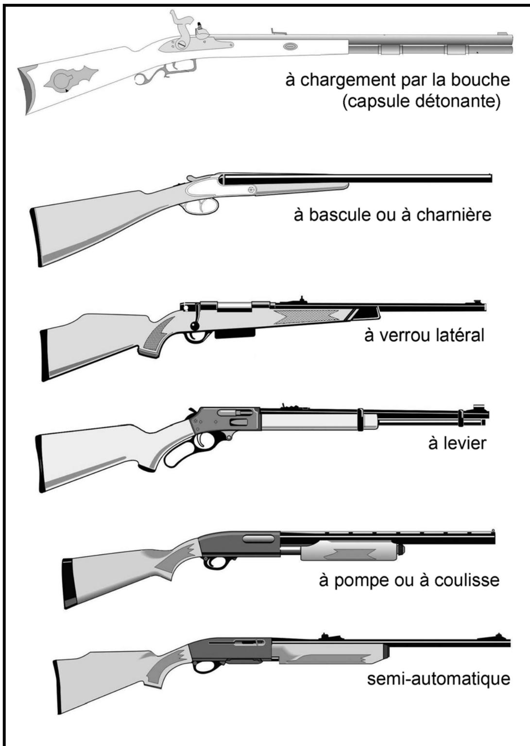
**Figure 40.** Types de mécanismes d'armes à feu
