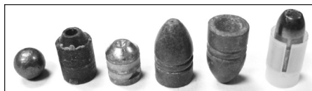
Balles : ronde, conique, conique lubrifiée, Minié (endroit et envers), balle avec sabot
